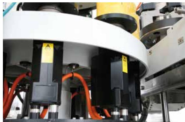
La Camme elettronica viene utilizzata per applicazioni speciali o per le diverse necessità di orientamento.
