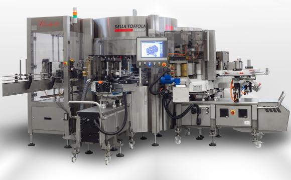
Nella versione **Z-Modulo** i gruppi di etichettaggio di tipologie diverse possono essere facilmente intercambiabili (es.: adesivo + colla a freddo).
