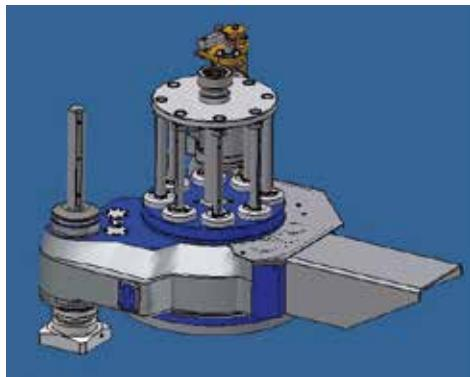
Il gruppo di etichettaggio a colla freddo Z-Cold Glue è completamente lubrificato a bagno d'olio.
