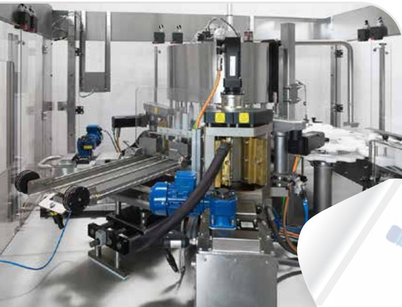
Un rullo colla inox provvede ad applicare la colla sul sormonto della etichetta stessa.
