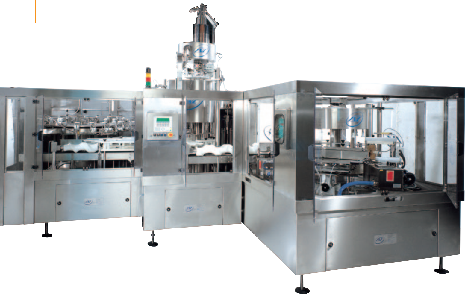
Uniblocco a gravità modello 20/20/6 in sincro con etichettatrice 6T H/M per riempire acqua in bottiglie da 5l PET Gravity Unibloc Model 20/20/6 in synchrobloc to a 6 head Hot Melt Labeller to fill water into 5lt PET containers
