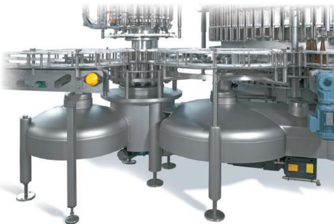
forma de domo para favorecer el drenaje del agua y de eventuales pedazos de vidrio. Estructura modular con configuración horaria/anti-horaria. Predispuesta para conectarse a una enjuagadora, a un tapador de rosca o corona, o en alternativa, a varios tapadores a la vez. Tracción de la mesa de transferencia de botellas mediante motor brushless sincronizado con el motor principal del carrusel de llenado.
