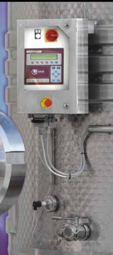
È UN SISTEMA BREVETTATO, CHE PERMETTE DI VISUALIZZARE IL LIVELLO DELLA MASSA PRESENTE NEL VINIFICATORE E DI RILEVARE LA DENSITÀ DEL MOSTO IN FERMENTAZIONE
