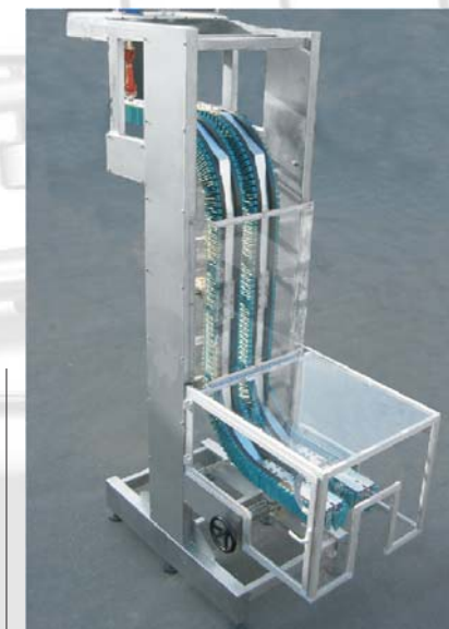
Elevatore / discensore bottiglie a tamponi Side grip conveyor for bottle elevation and descent Elévateur / descenseur à tampons pour bouteilles Elevador/descensor de botellas a tampones Захватывающий подъемник/опускатель бутылок
